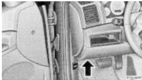
Lokalizacja wewnętrznej skrzynki bezpieczników
